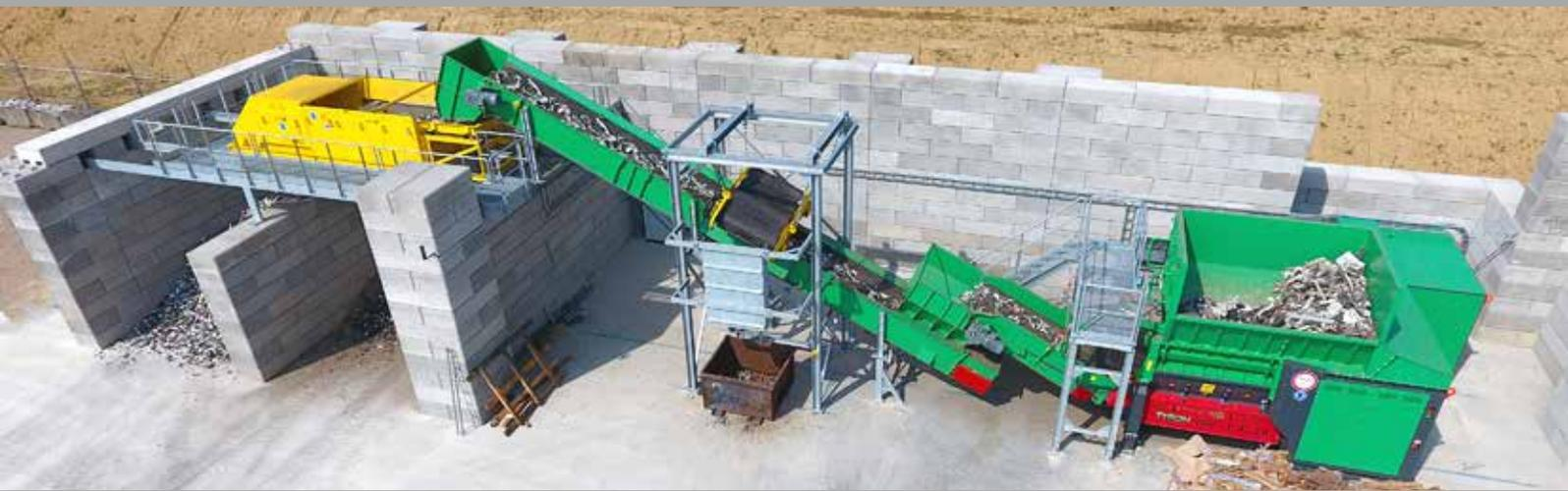
**Leichtschrott Kompaktanlage** Der TYRON -hier mit separatem Power-Pack- dient der Zerkleinerung von Aluminium und Leichtschrott. Auf diese Weise wird die optimale Körnung für die folgende NE- und FE-Abscheidung erreicht.
