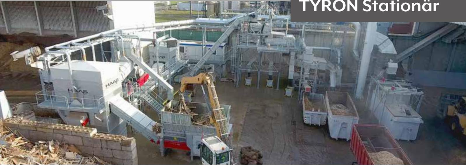
**Altholzrecyclinganlage** In der Kölner Großanlage für die Aufbereitung von ca. 120.000 Tonnen Altholz pro Jahr ist der stationäre TYRON die erste Maschine der Linie und bricht das Altholz der Klassen A I, A II und A III vor.
