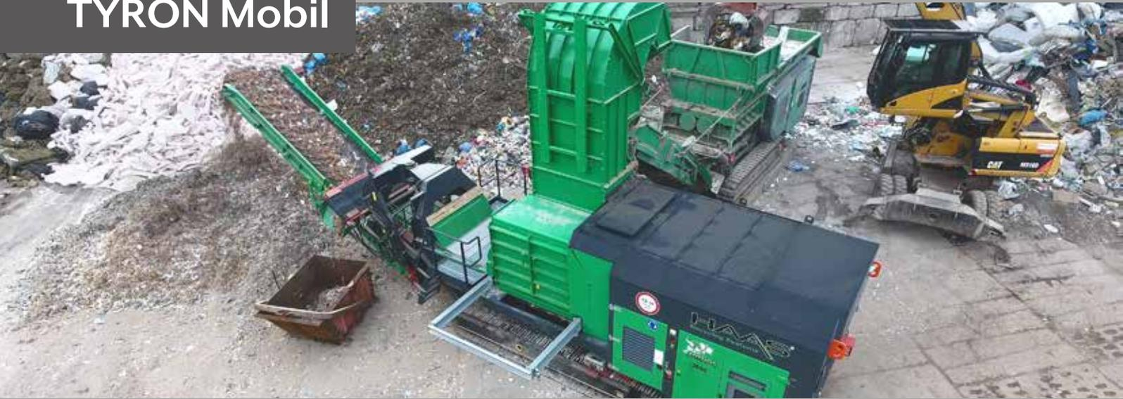
**TYRON & ARTHOS** Die mobile Hammermühle zerkleinert gründlich und schnell vorgebrochenes Altholz, Grünschnitt, Ersatzbrennstoffe und PVC-Abfälle.
