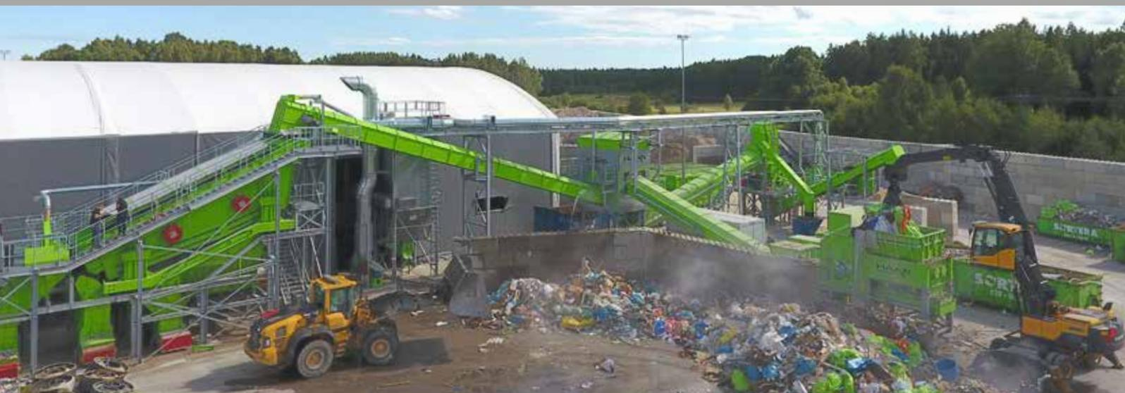
**Zerkleinerungs- und Sortieranlage** In Schweden „arbeitet“ der TYRON in einer kombinierten Altholz- und Gewer-
