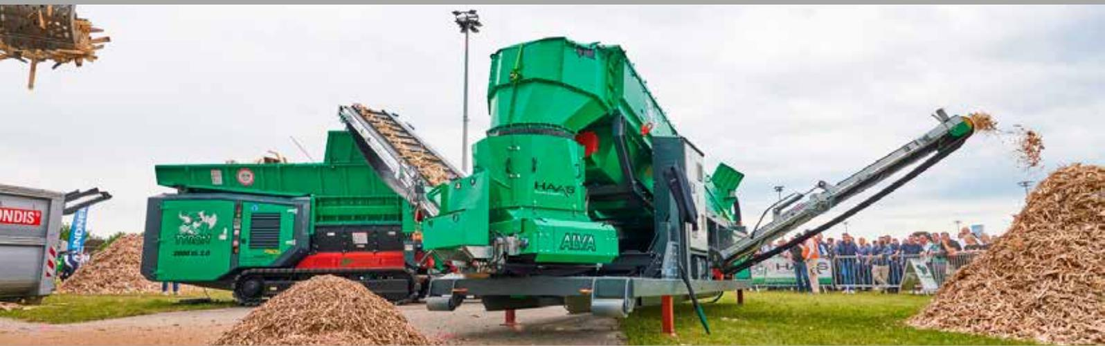
**TYRON & ALVA** Das mobile HAAS Sternsieb ist das perfekte Siebssystem für Grünschnitt, Wurzeln oder Altholz. Das Aussieben einer definierten Nutzfraktion erfolgt bei gleichzeitigem Rückführen von Überlängen in den Vorbrecher.
