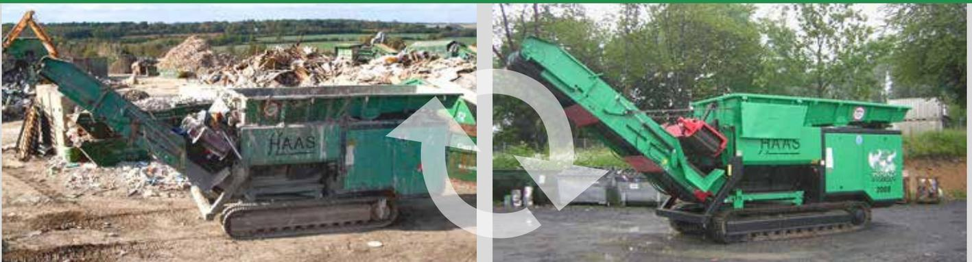
*Fotovergleich vor der Aufbereitung mit rund 15.000 Betriebsstunden und nach der Maschinenaufbereitung.*
