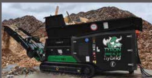
Für den Zerkleinerungsvorgang wird der hybrid-Vorbrecher über einen praktischen Schnellverschluss mit dem Stromnetz verbunden. Der neue TYRON hybrid bietet maximale Wirtschaftlichkeit und mobile Flexibilität mit dem Bonus für die Umwelt.
