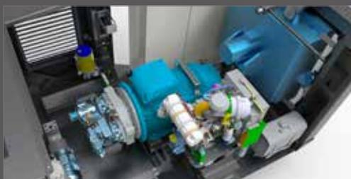
Unser hybrider TYRON ist für Höchstleistungen in der Zerkleinerung ausgelegt. Der Elektromotor bietet im Vergleich zum Dieselmotor aufgrund des hohen Wirkungsgrades einen deutlichen Vorteil in der Energieeffizienz. Bei konstant hohen Durchsatzleistungen können im Vergleich zu diesel-hydraulischen Antriebsvarianten bis zu 70 % Energiekosten eingespart werden.
