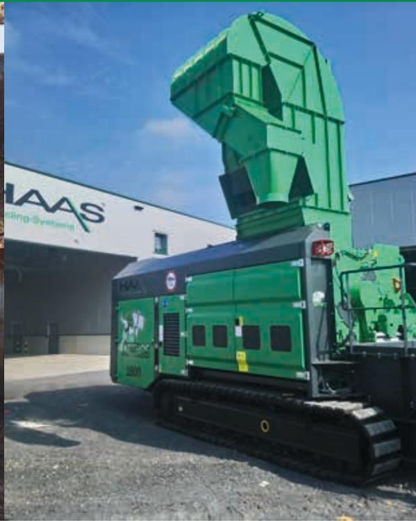
Die im stationären Einsatz seit Jahren bewährte Technik wird mobil und kommt zukünftig auf einem Kettenlaufwerk auch in schwierigstem Gelände mühelos voran. In Kombination mit dem Vorbrecher TYRON zerkleinert die Neuentwicklung aus Dreisbach gründlich und schnell Altholz, Grünschnitt, Ersatzbrennstoffe und PVC-Abfälle. Das Größenspektrum reicht von 30-150 mm. Störstoffe im Eingangsmaterial werden mithilfe des von HAAS entwickelten ballistischen Auswurfs automatisch abgeschieden.
