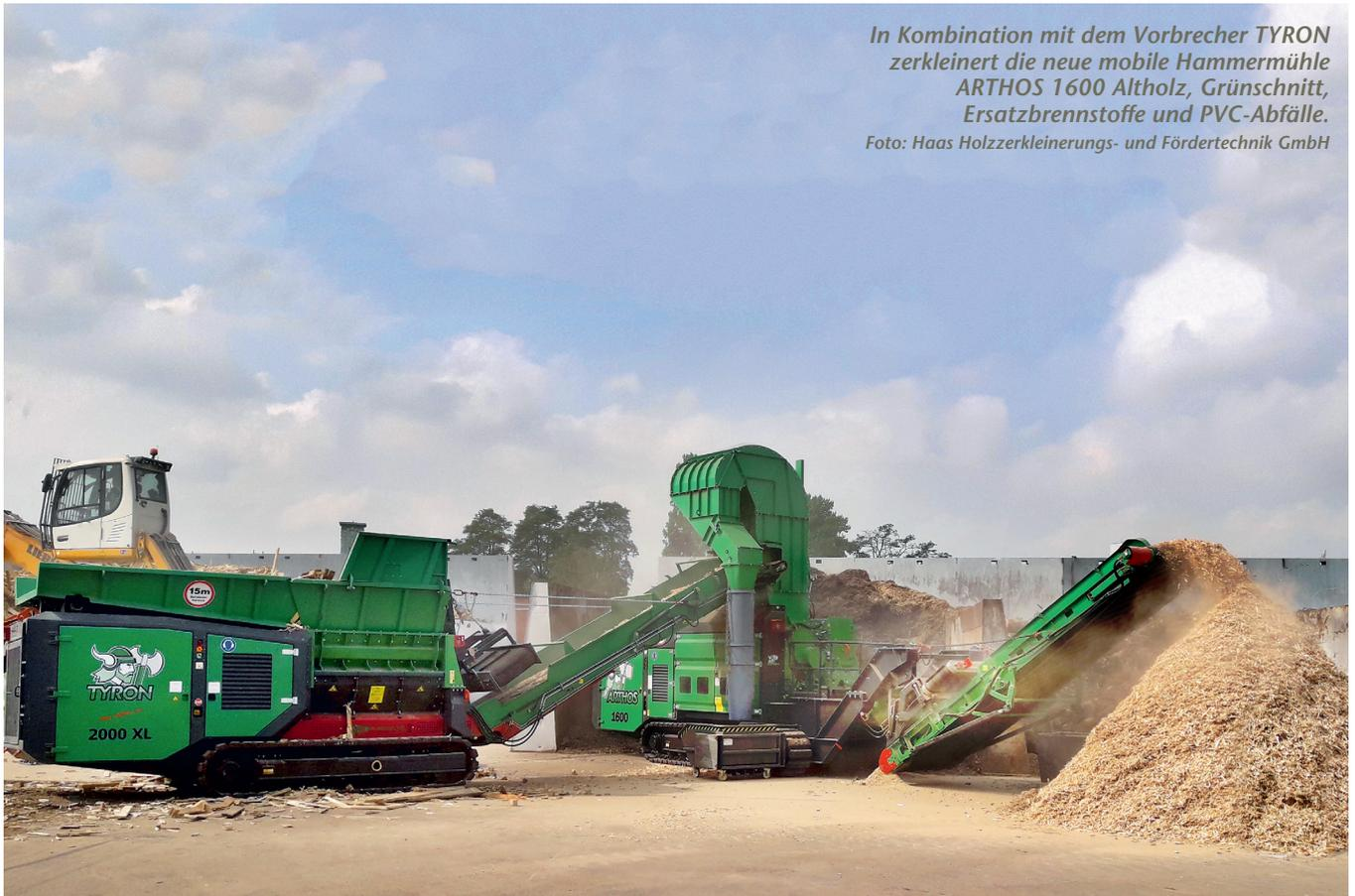
In Kombination mit dem Vorbrecher TYRON zerkleinert die neue mobile Hammermühle ARTHOS 1600 Altholz, Grünschnitt, Ersatzbrennstoffe und PVC-Abfälle.
