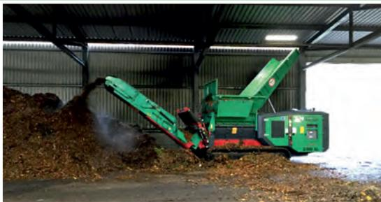
Neben der HAAS Altholzanlage, die seit über 30.000 h im Einsatz ist, und dem TYRON 2500, der zur Müllzerkleinerung eingesetzt wird, hat nun ein TYRON 2000 2.0 XL seine Arbeit aufgenommen. Die mit einem Feinwerkzeug ausgestattete Maschine stellt im Altholz und Grünschnitt, bei einer Leistung von weit über 30 t/h, ein homogenes 0-120/150 mm Material her und kann zusätzlich auch im Müll eingesetzt werden.
