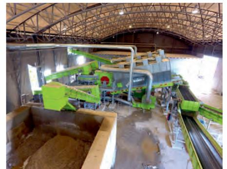
Im Jahr 2017 wurde eine HAAS Anlage in Betrieb genommen, die es ermöglicht im Jahr bis zu 120-150.000 Tonnen Industrie- und Gewerbemüll zu zerkleinern. Das Material wird vorzerkleinert, FE separiert, in 3 Fraktionen gesiebt (Feinanteil < 10 mm; 10-80 mm; > 80 mm) und einer Windsichtung zugeführt, um Schwergut zu trennen. Das Endprodukt wird in einem Kraftwerk zur Energiegewinnung verwendet.
