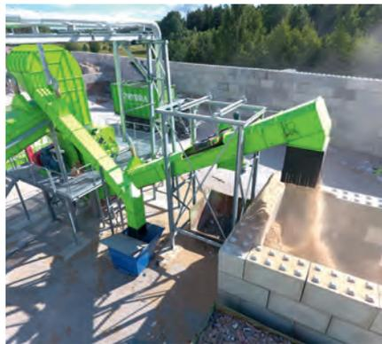
Nach dem Vorzerkleinerer TYRON 2500 E lässt sich über ein Reversierband auch eine zusätzliche Altholzlinie beschicken. Hier können mehr als 45 t/h < 80 mm über eine Hammermühle ARTHOS 1600 E nachzerkleinert werden.
