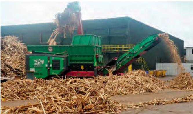
Aus dem recyceltem Holz werden unterschiedliche Produkte gewonnen, darunter Tierstreu, Biomasse für Heizkraftwerke und Recyclingspäne als Sekundärrohstoff für die Spanplattenindustrie. Bereits seit drei Jahren setzt Hadfield Wood Recyclers einen HAAS Doppelwellen-Vorbereiter für die Holzzerkleinerung am Standort Tilbury im Südosten Londons ein. Ein dritter TYRON wurde erst kürzlich bestellt und wird zukünftig ebenfalls seine Stärke in Tilbury unter Beweis stellen.
